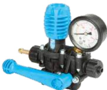
VALVOLA REGOLAZIONE PRESSIONE PER MEDIE PORTATE (15÷30 L/MIN), COMPLETAMENTE IN POLIPROPILENE E SEDE IN ACCIAIO INOX AISI 316, PER APPLICAZIONI PROFESSIONALI, COMPLETA DI UN ESCLUSIVO SISTEMA DI CHIUSURA ON/OFF A DEVIAZIONE TOTALE, ALTA PRECISIONE DI REGOLAZIONE, AD OGNI CICLO, GRAZIE AL PRINCIPIO DI REGOLAZIONE INDIRETTA DEL FLUSSO, CON MANOMETRO A 1 O 2 USCITE.
