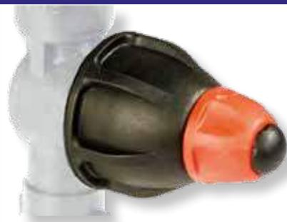
IL NUOVO ANTIGOCCIA CON RUBINETTO PERMETTE DI CHIUDERE OGNI SINGOLO PORTAGETTO SEMPLICEMENTE RUOTANDO LA MANOPOLA POSTA SULL'ANTIGOCCIA, SENZA L'AGGIUNTA DI RUBINETTI SUPPLEMENTARI, GARANTENDO UN ELEVATO RISPARMIO ED UNA RESA OTTIMALE DELL'IMPIANTO, IL FUNZIONAMENTO DEL SISTEMA ANTIGOCCIA RIMANE INVARIATO.
